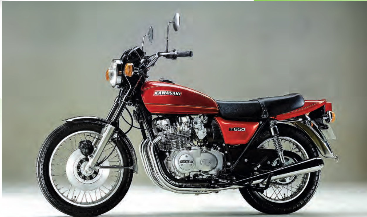
647 ccm, Vierzylinder-Viertakt, zwei obenliegende Nockenwellen, 66 PS, Scheibenbremse vorn.
