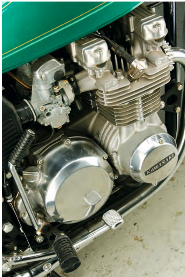
647 ccm, Vierzylinder-Viertakt, zwei obenliegende Nockenwellen, 66 PS, Scheibenbremse vorn.
