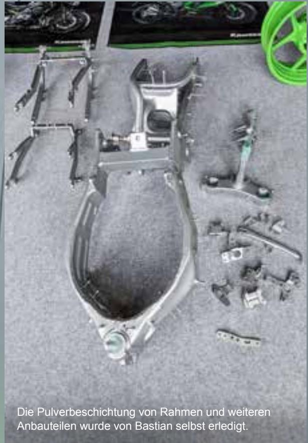
Die Pulverbeschichtung von Rahmen und weiteren Anbauteilen wurde von Bastian selbst erledigt.
